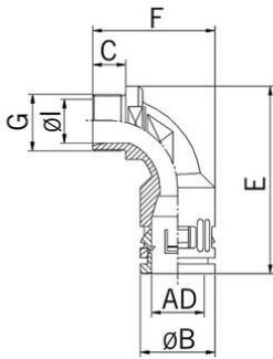
**Tubo flessibile avvitato sintetico curva di collegamento a vite a 90° a tenuta conica**
