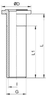
**Kst-Kabeldurchführung Fassade M25/M20**
