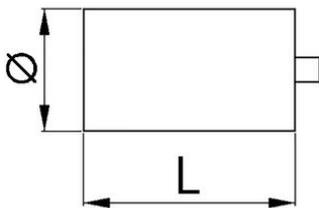
**Verschlussbolzen aus Kunststoff zu Mehrfach-Kabelverschraubungen**
